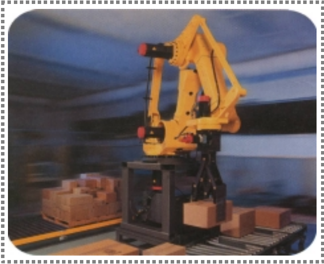
집어제자리놓기 컴퓨터조종산업로봇은 생산에서 작업흐름을 가능하도록 방조한다. 여기 FANUC로봇은 집어제자리놓기기능에 의해 콘베아들사이로 함들을 옮겨 놓는다. 이 로봇은 초당 130폰드이상의 함을 처리할수 있다.
